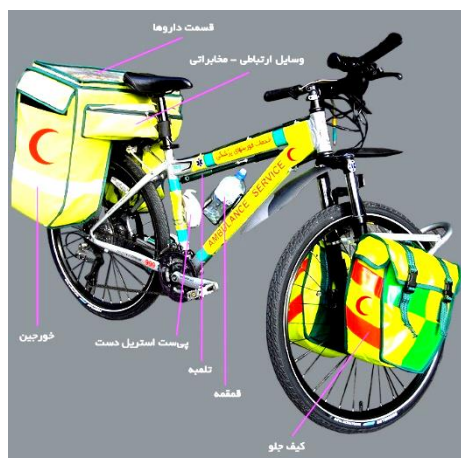
شکل-۳. خورچین عقب برای قرارگیری روی چرخ عقب دوچرخه امداد
